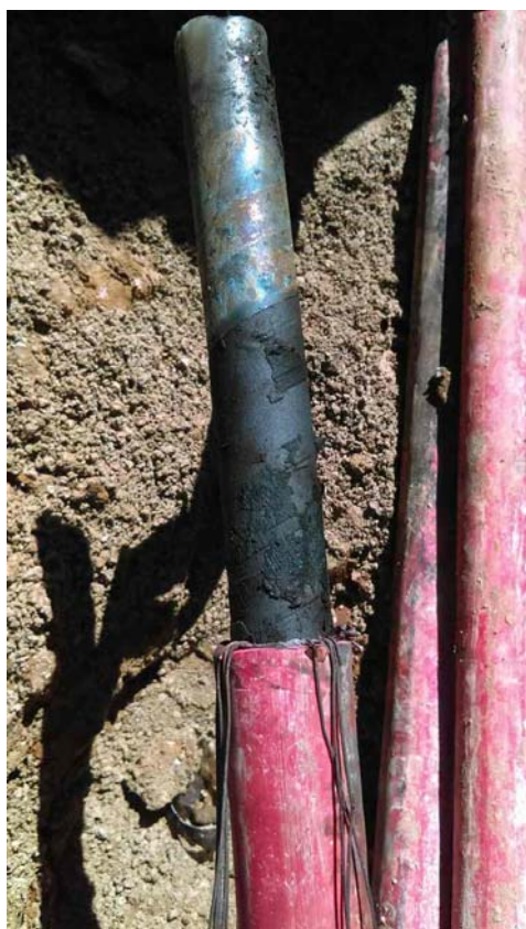
Slika 5. „Nezdravo“ stanje zaslona izolacije
